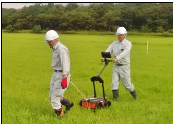
【写真】地中探査レーダー調査
