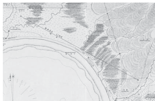
【図1】北海道三角術測量 函館助基線之図（抜粋） 函館市中央図書館所蔵
